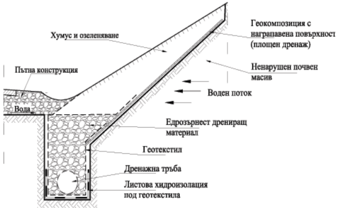
Фигура 129. Площен дренаж, лежащ по откоса и отвеждащ водата на нивото на подокопен дренаж с геотекстил 5. предпазен окоп в горния край на откоса, комбиниран с подокопен дренаж, изпълнен с геотекстил, съгласно фигура 130;
