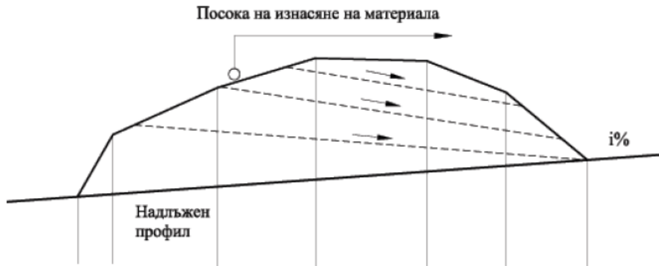
Фигура 142. Отводняване на изкоп при изнасяне в посока, обратна на надлъжния наклон
