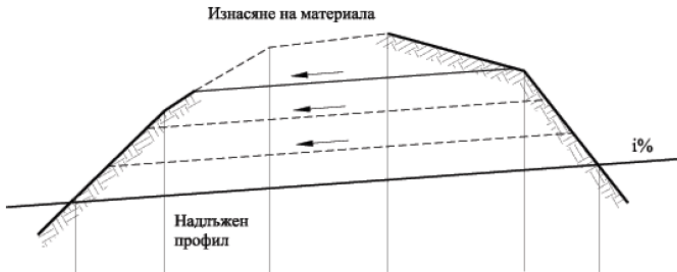
Фигура 141. Отводняване на изкоп в надлъжно направление
