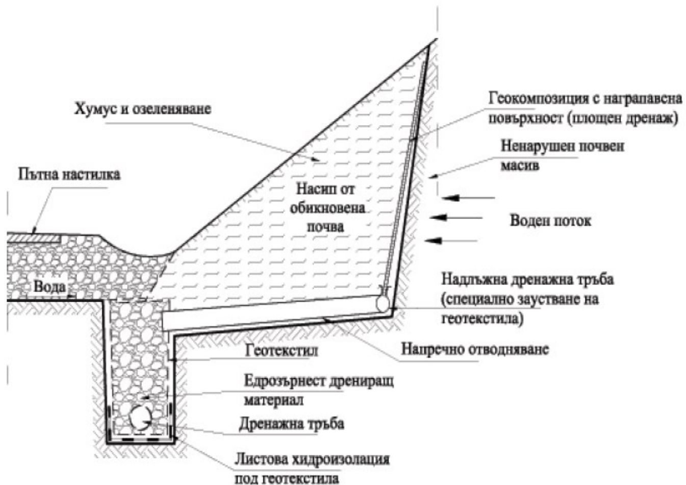
Фигура 131. Площен дренаж под голям наклон, комбиниран с отвеждане на водата в подокопен дренаж с геотекстил 7. отводняване на обратна засипка съгласно фигура 132;
