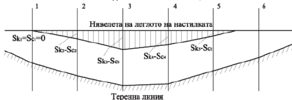
Фигура 105. Надлъжна крива на слягането, когато то се реализира в проектния експлоатационен период на пътната конструкция
