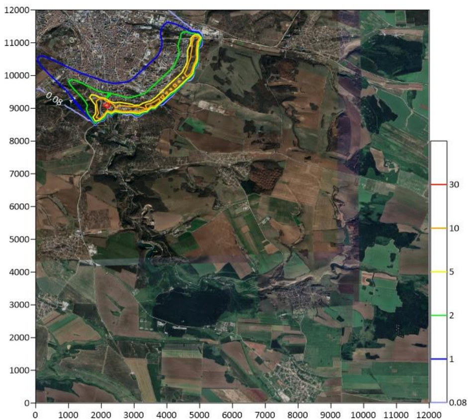
Изолинии на СЧК на NOx в приземния слой на атмосферата, \mu\text{g}/\text{m}^3 , червен вариант.
