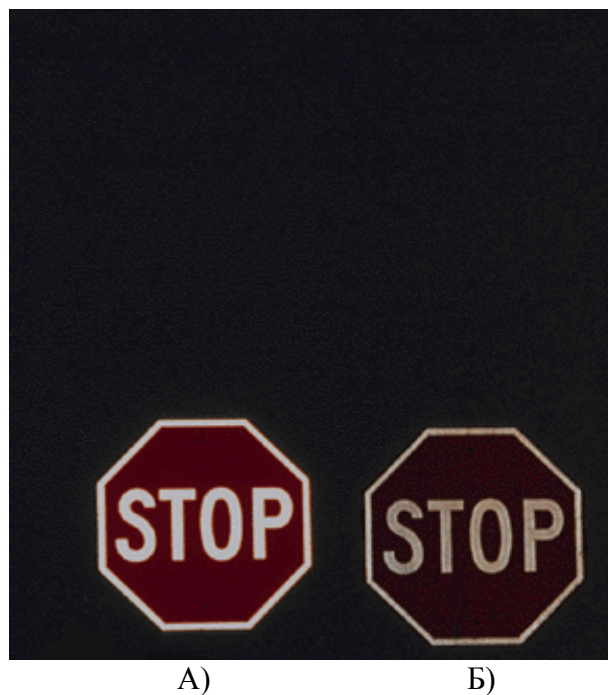
Фигура 2: Нощна видимост на светлоотразителни пътни знаци с фолио клас RA1: А)-съответства; Б) не съответства
