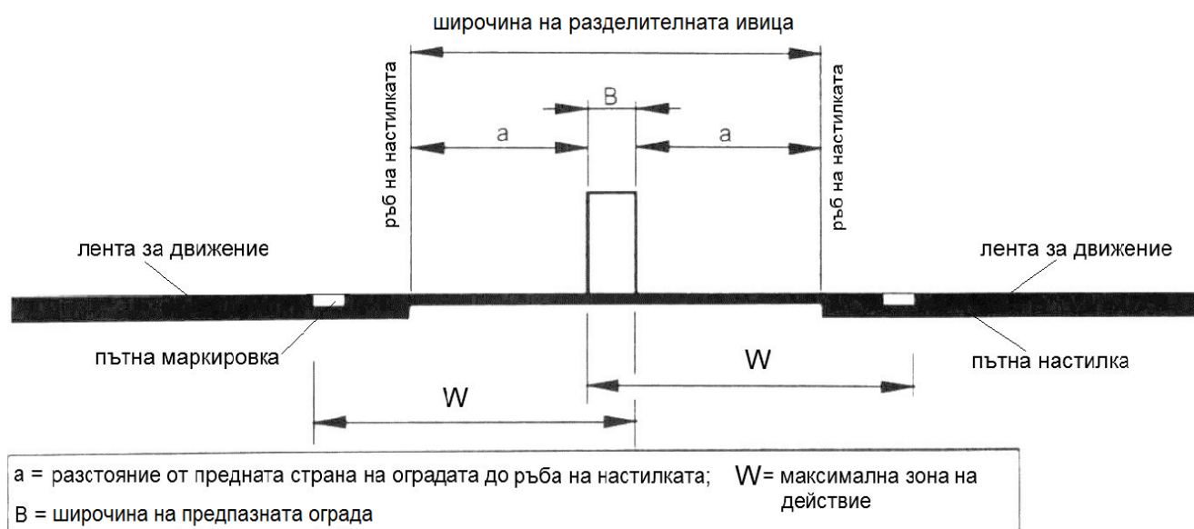
Фигура 15. Двустранна ограничителна система за пътища, разположена в оста на разделителната ивица
