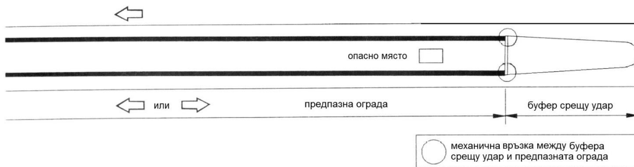
Фигура 20. Ограничителна система изградена двустранно в разделителната ивица от едностранна ограничителна система за пътища с буфер срещу удар за начало
